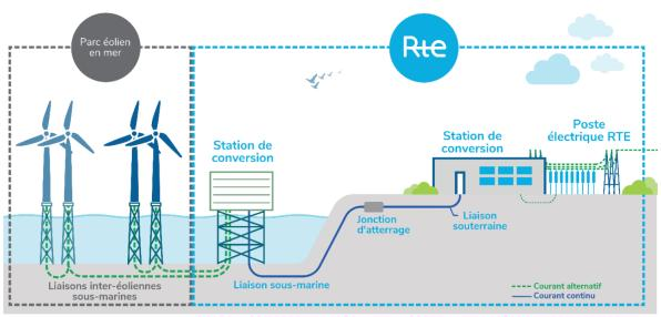
Gestionnaire du réseau public de transport d'électricité en France, RTE est chargé de raccorder le futur parc éolien au réseau public de transport d'électricité. Les ouvrages du raccordement se composent d'une plateforme en mer depuis laquelle l'énergie produite par les éoliennes est transportée jusqu'au réseau public de transport d'électricité terrestre grâce à des liaisons électriques sous-marines et souterraines.
